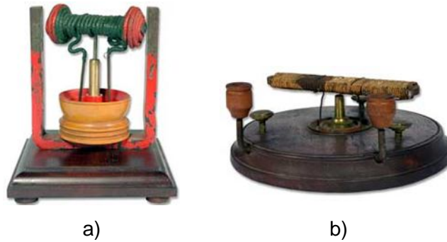
Figura 8: motores con conmutador de W. Sturgeon a) y W. Ritchie b).
