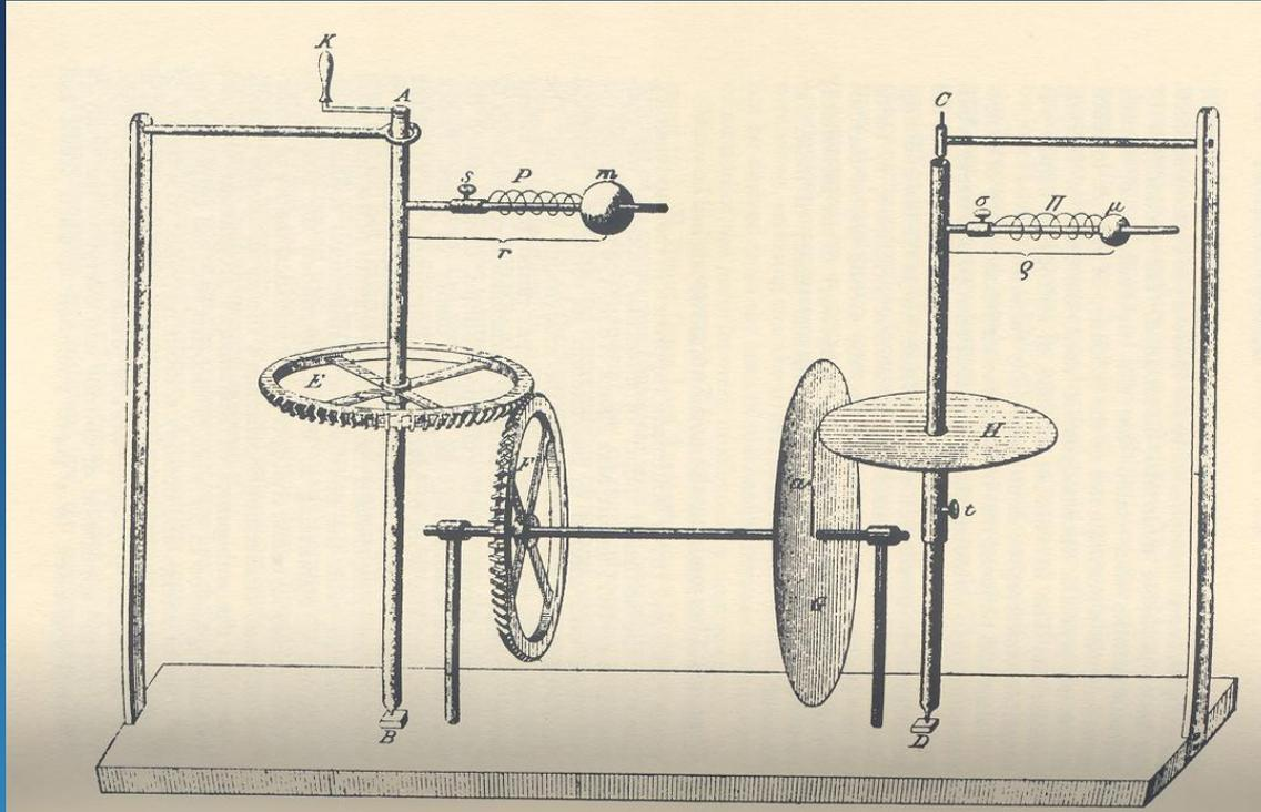
Modelo mecánico de Boltzmann para ilustrar el segundo principio de la termodinámica (1884)
