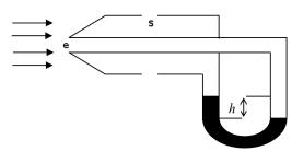
**Problema 6:** En la figura se representa un tubo en U, dispuesto verticalmente, que está abierto en ambos extremos y parcialmente lleno de agua. El brazo derecho está protegido de cualquier movimiento del aire. Se sopla a través de la parte superior del brazo izquierdo con una velocidad de viento v, tal que se observa una diferencia de nivel de agua entre ambos tubos  $h = 1 \,\mathrm{cm}$ .
