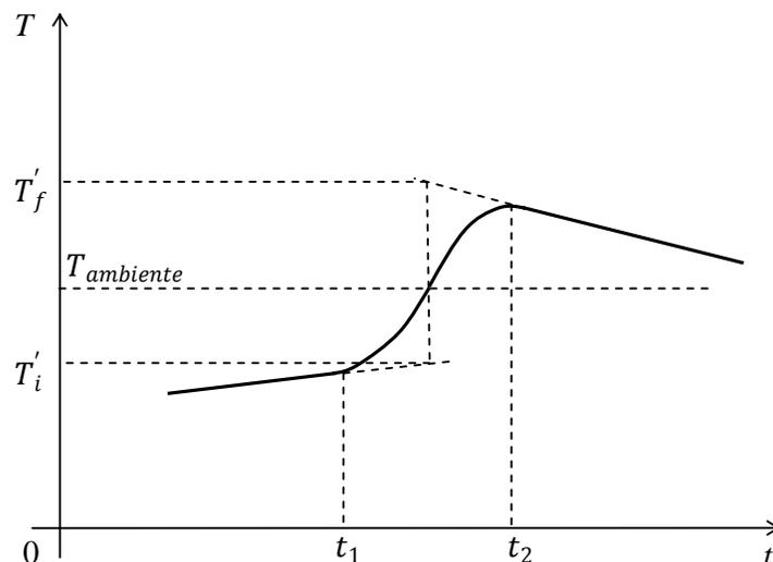
Figura 2: Grafico de la temperatura del sistema en función del tiempo al introducir un cuerpo más caliente que inicialmente el calorímetro.
