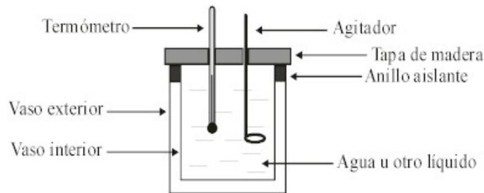
Figura 1: Calorímetro de las mezclas
