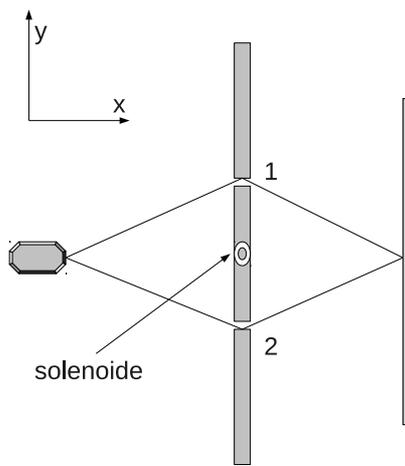
modificación: se coloca un solenoide de área transversal  $a$  y de longitud infinita en la dirección  $z$  entre las rendijas. De esta forma el campo magnético queda confinado siempre dentro del solenoide. Considerando conocidas las soluciones sin campo calcule,
