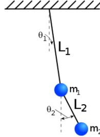
Las ecuaciones de movimiento para el péndulo doble se derivan en forma directa del *Lagrangiano* del sistema:
