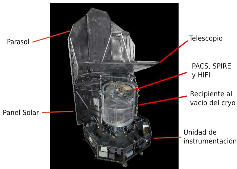
Figura 2.1: Nave Espacial Herschel. Se indican las componentes principales de la nave. Imagen tomada y adaptada de la página https://inspirehep.net/record/856535/plots .
