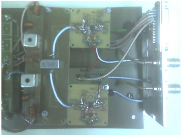
Figura 78: Construcción de 2 amplificador de RF de adaptación y un filtro, detalle de conexión con el DDS.
