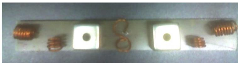
Figura 89: Construcción del filtro pasivo @60MHz.
