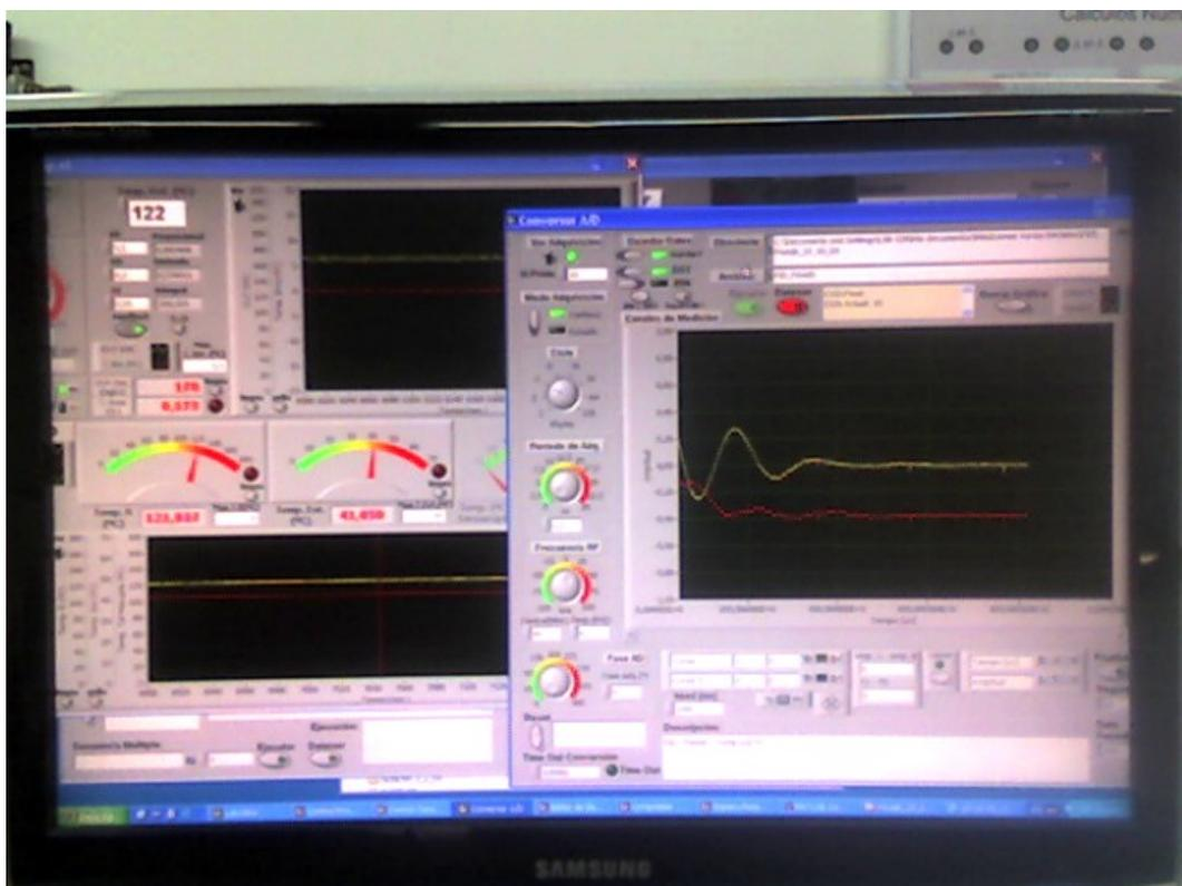
Figura 106: Medición de una señal de RMN y programa del control de temperatura.
