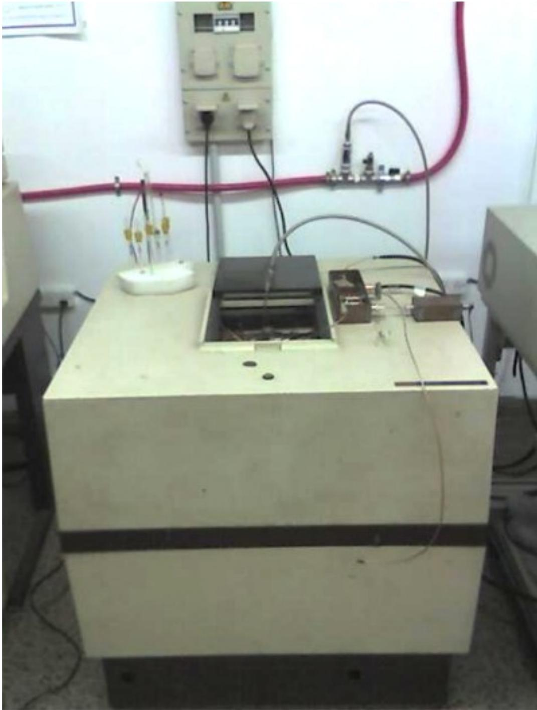
Figura 100: Imán permanente. Campo magnético de 60MHz para protones.
