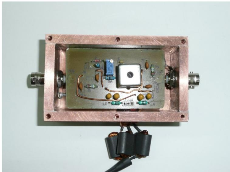
Figura 85: Construcción del Filtro activo.
