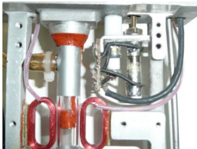
Figura 60: Construcción de la malla de acople en el 'probe'. Pueden verse el capacitor de sintonía (de mayor tamaño) y el de 'matching' (de menor tamaño) junto con la bobina de RF (de color rojo, dentro del tubo).
