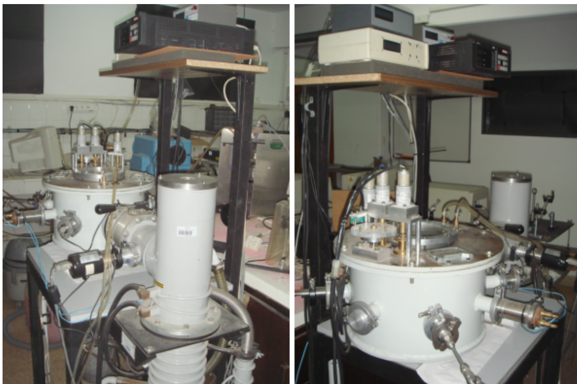
Figura 2.7: Fotografía del equipo de DLP desarrollado
