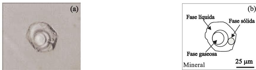
Figura 7-8. Inclusión fluída en esmeralda proveniente de la región Capoeirana, Minas Gerais (Brasil). (a) Microfotografía; (b) Diseño esquemático.
