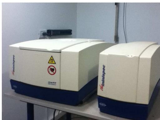
Figura 4.1: Espectrómetro BRUKER MINISPEC mq 20 utilizado para realizar los experimentos.
