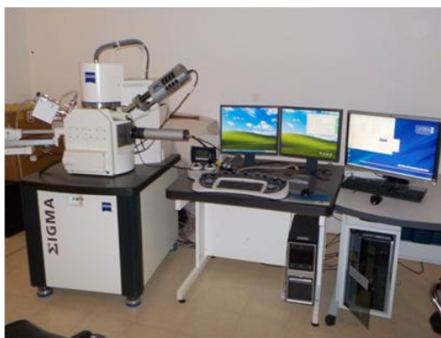
Figura 2.5: Equipamiento utilizado para la medición con SEM y microanálisis. FaMAF.
