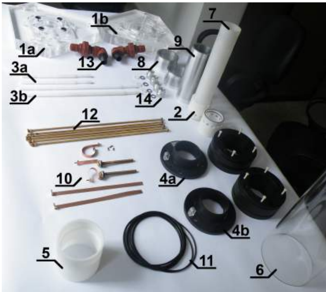
FIGURA 6.11: Desmonte del conjunto. Los números indican: 1a. Plancha superior, b. Plancha inferior, 2. Entrada y salida del líquido de la capa interna, 3. Varilla roscada del a. Cápsula de montaje del Notch superior, b. Cápsula de montaje del Notch inferior, 4a. Cápsula de montaje del Notch superior, b. Cápsula de montaje del Notch inferior, 5. Cilindro de bloqueo del fluido, 6. Cilindro de vidrio, 7. Cilindro de sellado interno de la cámara de refrigeración, 8. Notch, 9. Capa interna, 10. Conexiones eléctricas, 11. Anillos aislantes, 12. Varillas roscadas de bronce, 13. Conexiones para la entrada y salida del líquido, 14. Perillas de comando para la posición de los Notch.
