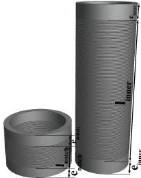
FIGURA 6.1: Vista esquemática del cilindro o capa interna con una capa Notch correspondientes al prototipo elaborado.
