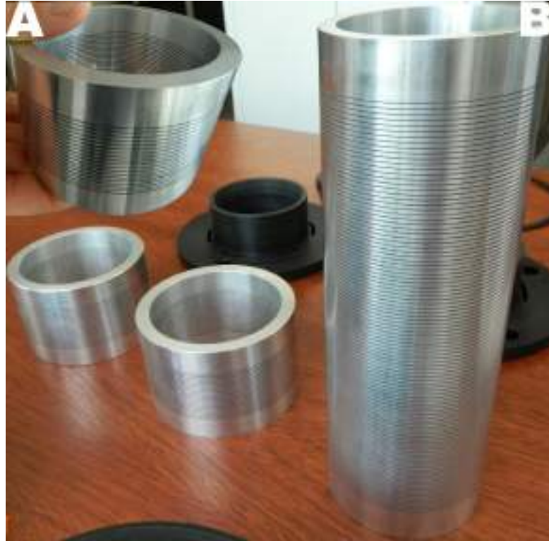
FIGURA 6.8: Cilindros que conforman el electroimán tipo Notch de geometría variable. A) Cilindro Notch, B) Sistema desarmado.
