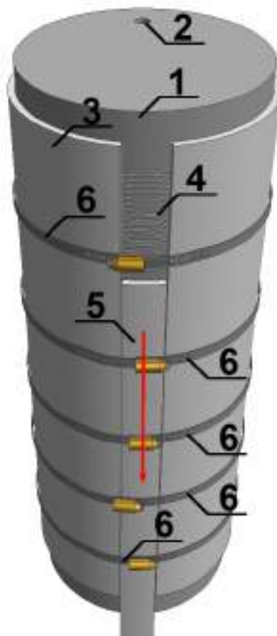
FIGURA 6.6: Visualización de la configuración para el procedimiento de sellado. Los números simbolizan: 1. Cilindro de aluminio, 2. Perforación, 3. Cilindro plástico, 4. Corte helicoidal, 5. Parte móvil, 6. Abrazaderas. La flecha roja indica el movimiento de la parte móvil durante el proceso de sellado.
