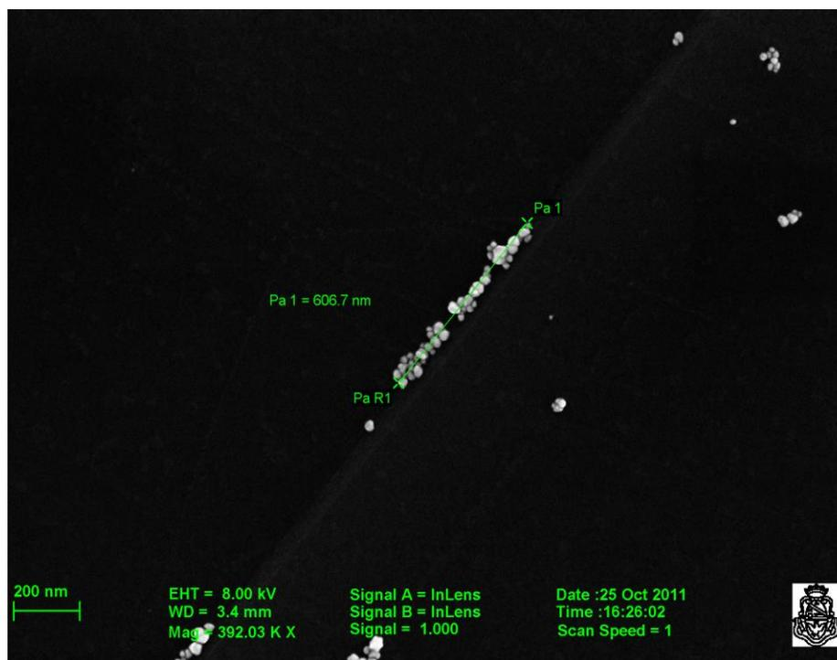
Figura 3.12: Imagen obtenidas a través de SEM de nanoestructuras de Au /HOPG-tiempo de deposición 10 s
