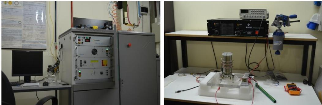
Equipos del LaRTE: a la izquierda, un Relaxómetro; a la derecha, un montaje para calibrar los gausímetros que ofrece Trovintek.
