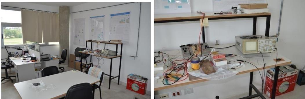
A la izquierda, vista general del interior de la oficina de Trovintek en la IE. A la derecha, un osciloscopio que se utiliza para la elaboración de los gausímetros.
