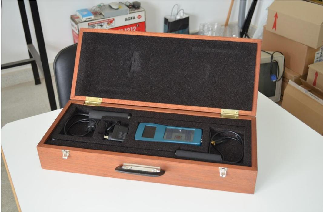
Presentación del segundo prototipo de gausímetro creado en el LaRTE. El primer prototipo continúa utilizándose actualmente en ese Laboratorio.
