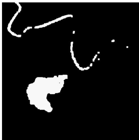
(e) Resultado de la aplicación de un operador morfológico de apertura con el elemento estructurante  $E_{3,5}$
