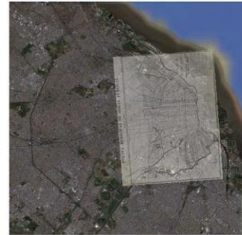
(C) Se georregistra manualmente, transparentando la imagen de forma de poder visualizar los límites en GE y buscando la coincidencia entre ambos.
