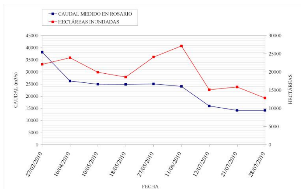
Figura 6.3: Comportamiento del caudal del Río Paraná medido en Rosario (Santa Fe) vs. el número de hectáreas inundadas detectadas por el conjunto de datos CSK utilizado.
