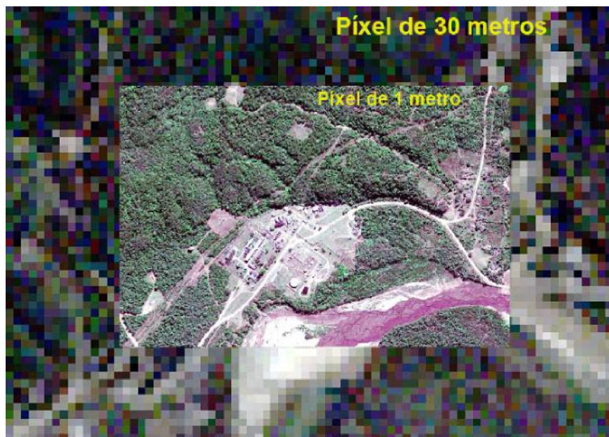
Figura 3.5: Diferenciación de distintas coberturas terrestres según su resolución espacial. Imagen Landsat 5 TM (píxel de 30 m) vs QuickBird (píxel de 1 m).
