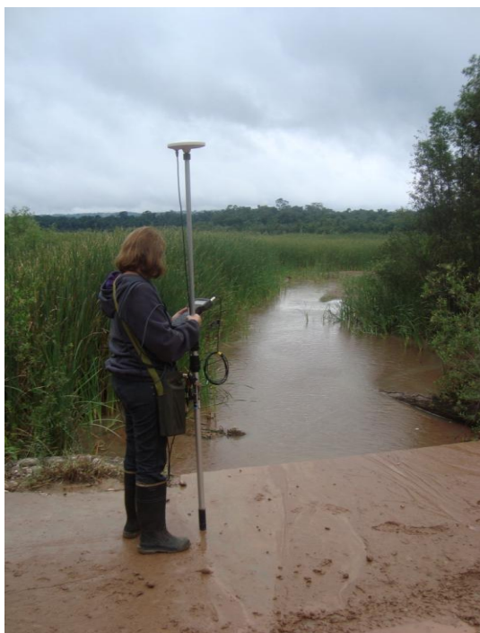
Figura 1. Registro de uno de los puntos de control terreno (GCP) con el rover del DGPS.
