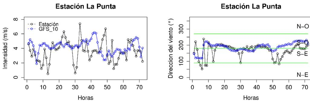
FIGURA 4.43: Comparación de la evolución de la intensidad y dirección del viento registrados y pronosticados.
