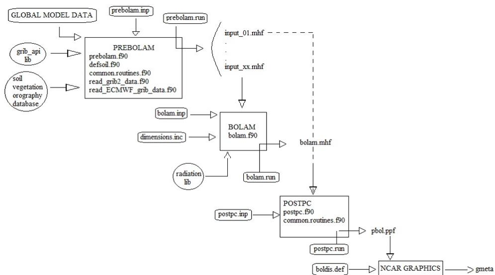
FIGURA 3.12: Diagrama de flujo del modelo BOLAM.
