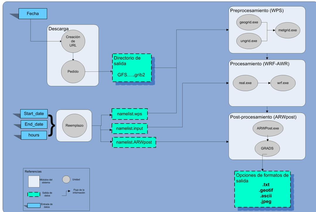
FIGURA 3.11: Diagrama de flujo de la automatización del pronóstico del tiempo.
