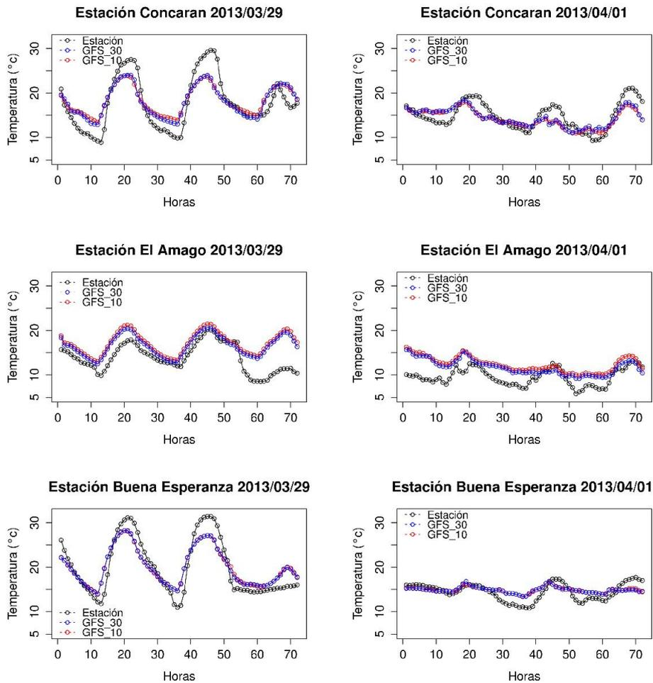
FIGURA 4.35: Comparación de la evolución de la temperatura registrada y pronosticada para tres diferentes estaciones.
