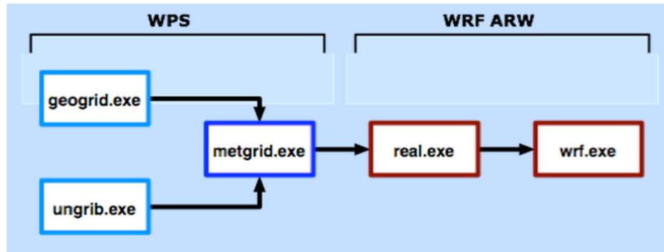
FIGURA 3.4: Diagrama de flujo del preprocesamiento y procesamiento.
