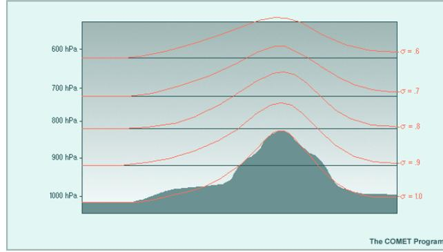
FIGURA 2.3: Representación esquemática de las coordenadas sigma.
