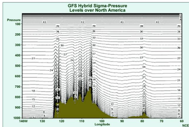
FIGURA 2.5: Representación esquemática de las coordenadas híbridas utilizadas por el GFS.
