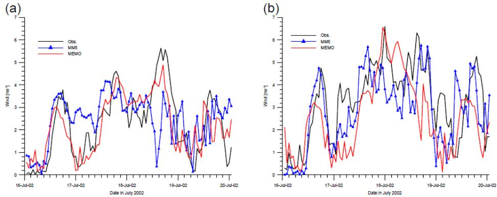
FIGURA 4.2: Comparación de patrones de intensidad de vientos modelados y medidos.
