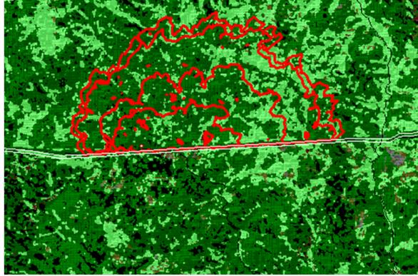
FIGURA 6.1: Simulación realizada con el modelo FARSITE: propagación del frente de fuego a distintos tiempos.
