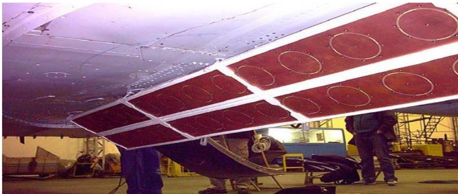
Figura B.3: Sensor Aerotransportado SARAT
