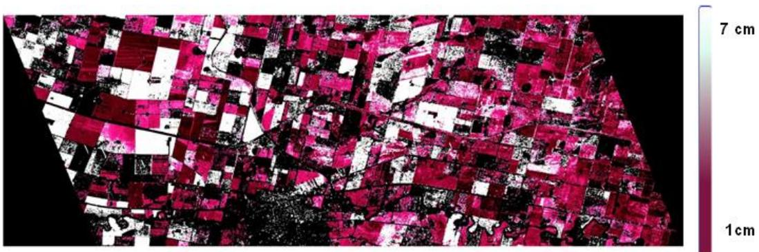
Figura 56: Mapa de Rugosidad Superficial del suelo (cm), Prov. Córdoba, Modelo IEM ajuste  $s/l=0.055$ , UAVSAR.
