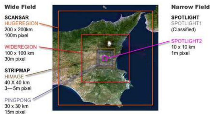
Figura 3.3: Resolución espacial de los modos de adquisición del sensor COSMO SkyMed. Imagen extraída de e-GEOS.
