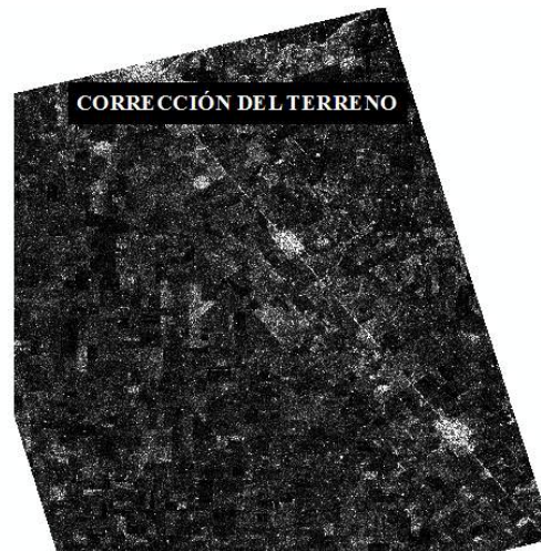
Figura 4.2: Imagen SAR final, resultante del preprocesamiento, en valores de intensidad y georeferenciada.
