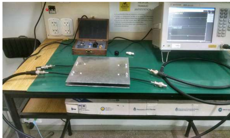
Figura 5.9: Configuración para la medición de los parámetros S de los módulos fabricados
