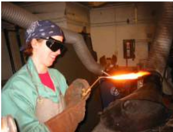
Soldadura a gas
