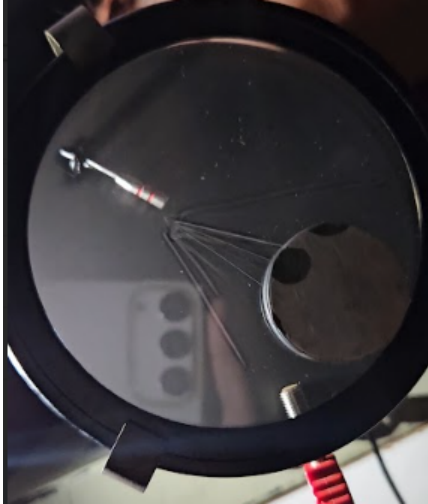
Figura 9: Experiencia con la cámara de Wilson utilizando alcohol etílico al 70 %.
