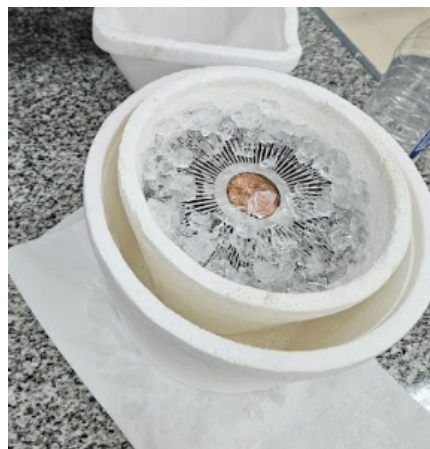
Figura 5: Fuente fría, la cual consta de un recipiente con hielo triturado, sal y un dissipador.
