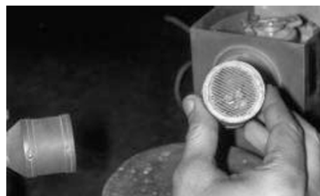
Figura 1: A la derecha una de las antenas de bocina emisoras de Bose, a la izquierda la bocina receptora.
