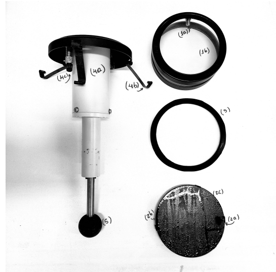
Figura 2: Cámara de Wilson utilizada
