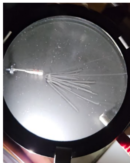
Figura 8: Experiencia con la cámara de Wilson utilizando alcohol etílico al 96 %.
