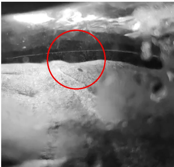
Figura 10: Niebla observada en el interior de la cámara notándose más en el área remarcada. La imagen fue editada, aumentándole el contraste y utilizando un filtro blanco y negro.
