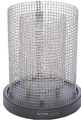
Figura 23: Cacharro de Faraday Pasco (Faraday Ice Pail). El recipiente interior es el cacharro propiamente dicho, el exterior es el blindaje.
