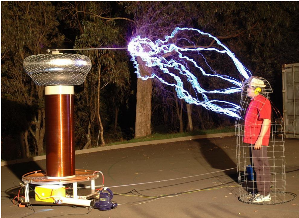
Figura 22: blindaje electrostático mediante una jaula de Faraday aplicado a una descarga eléctrica de alta tensión.
