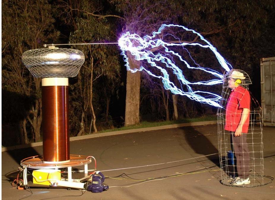
Figura 21: blindaje electrostático mediante una jaula de Faraday aplicado a una descarga eléctrica de alta tensión.
