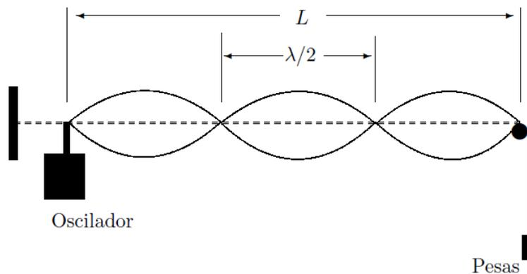
El oscilador es de frecuencia variable  $\nu$  y la tensión  $T$  de la cuerda es regulada mediante las pesas que se cuelgan del extremo libre. Es importante evaluar adecuadamente las apreciaciones con las cuales pueden determinarse  $\nu$  y  $T$ .
