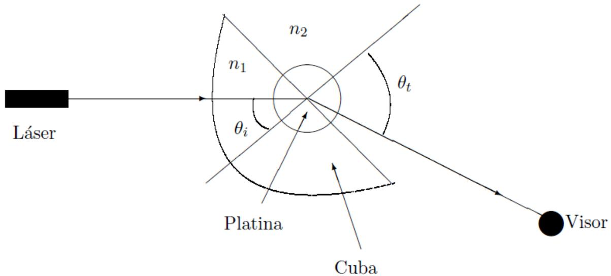
Figura 2: Esquema del montaje experimental para la determinación del índice de refracción utilizando reflexión total y ley de Snell.
