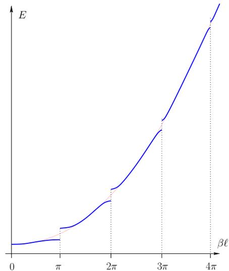
pequeña, la agitación térmica puede hacer que algunos electrones pasen de la banda de valencia a la de conducción, de manera que el material se comporta parcialmente como conductor: son los llamados *semiconductores*.
