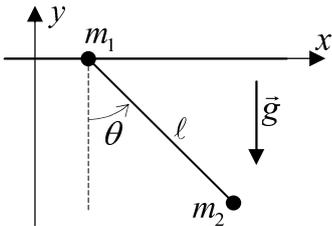
**Problema 3:** Determine las frecuencias y modos normales para las pequeñas oscilaciones de un péndulo de masa  $m_2$  y longitud  $\ell$  cuyo punto de soporte es la masa  $m_1$ , la cual puede moverse libremente sobre un eje horizontal como se muestra en la figura.
