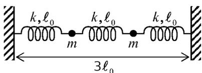
**Problema 6:** Determine las frecuencias y modos normales de vibraciones longitudinales del sistema de la figura, e intérpretelos físicamente.
