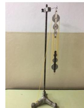
Realizar el mismo procedimiento que para la polea móvil y, a partir del gráfico, obtener la relación  $P/Q$  para este sistema.
