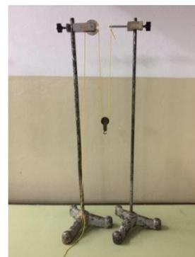
Una vez armado el dispositivo, colgar distintas masas de peso conocido ( $Q$ ) de la polea móvil y medir, la fuerza necesaria para sostener al cuerpo en equilibrio ( $P$ ). Armar una tabla de valores (con su incerteza correspondiente). Realizar un gráfico de  $P$  en función de  $Q$  y a partir de él obtener la relación  $P/Q$  para este sistema. Expresar la relación general que vincula la fuerza aplicada y la carga ( $Q$ ) para un sistema formado por una polea móvil.
