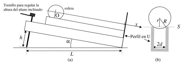
Figura 1: Vista lateral (a) y frontal (b) del dispositivo experimental.
