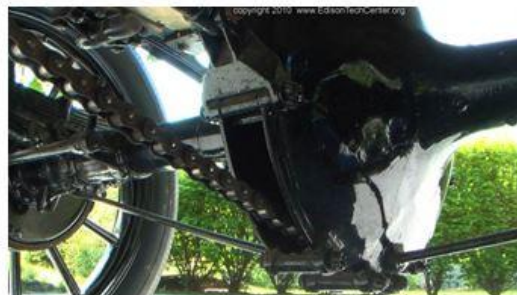
Figura 2: Foto de la transmisión a cadena de un vehículo eléctrico Baker 1907
