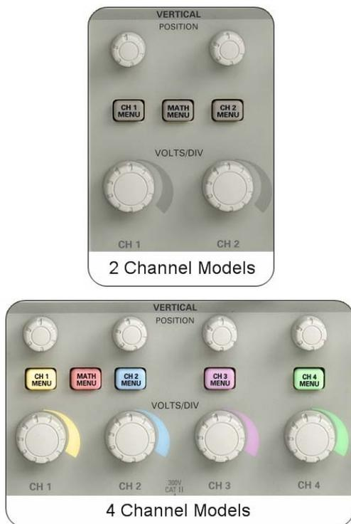
**Figure 3.1: TDS1012B and TDS2024B VERTICAL control section**
